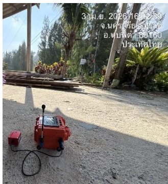
รูปที่ 3.3 - 1 การตรวจวัดแรงดันสะท้อนบริเวณบ้านของราษฎรหลังที่อยู่ใกล้พื้นที่โครงการมากที่สุด
