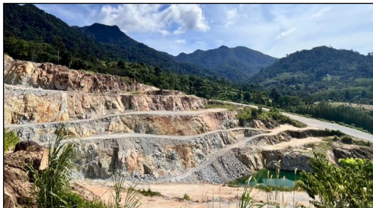
รูปที่ 2.27 โครงการออกแบบหน้าเหมืองให้มีชั้นบันไดให้ปลอดภัยเสมอ
